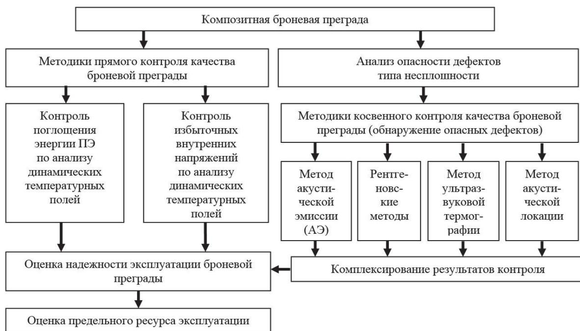
Рис. Структурная схема новой комплексной технологии контроля композитной броневой преграды с оценкой предельного ресурса эксплуатации
