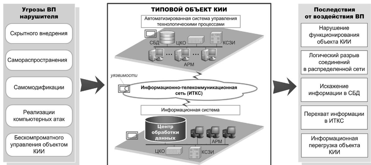
Рис. 1. Модель процессов функционирования типовых объектов КИИ в условиях ВП нарушителя
