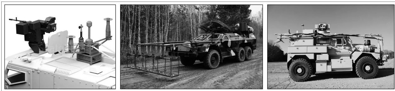
Рис. 2. Техника разминирования направленным излучением
