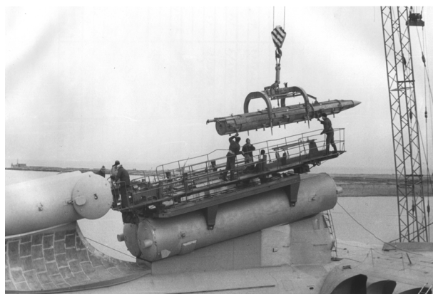
Рис. 5. Погрузка бросковой болванки на РКЭ «Лунь»
