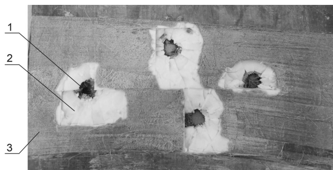
Рис. 3. Тыльная сторона экрана после препарирования: 1 — отверстие от пули; 2 — отслоившаяся часть экрана (конус Герца); 3 — приклеенная к экрану подложка
