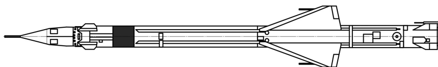
Рис. 4. ЗУР 5Я24. Закрашен отсек БЧ
