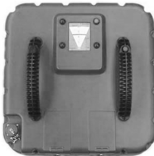
Рис. 3. Радиолокатор для поиска живых людей
