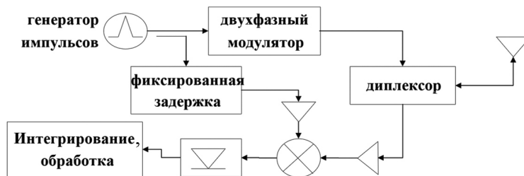
Рис. 9. Архитектура взрывателя UWB #1
