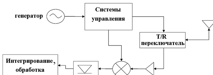
Рис. 10. Архитектура взрывателя UWB #2
