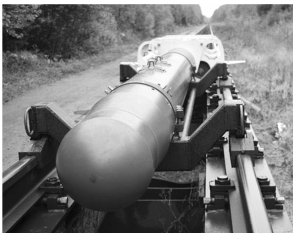
Рис. 2. Общий вид крепления объекта испытаний к разгонной каретке
