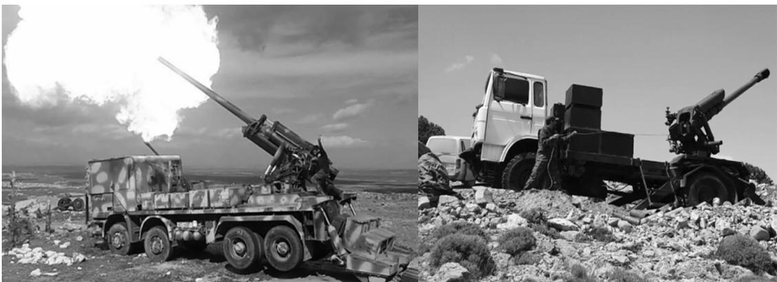
Рис. 2. Размещение артиллерийских орудий М-46 и Д-30 на грузовых базовых шасси
